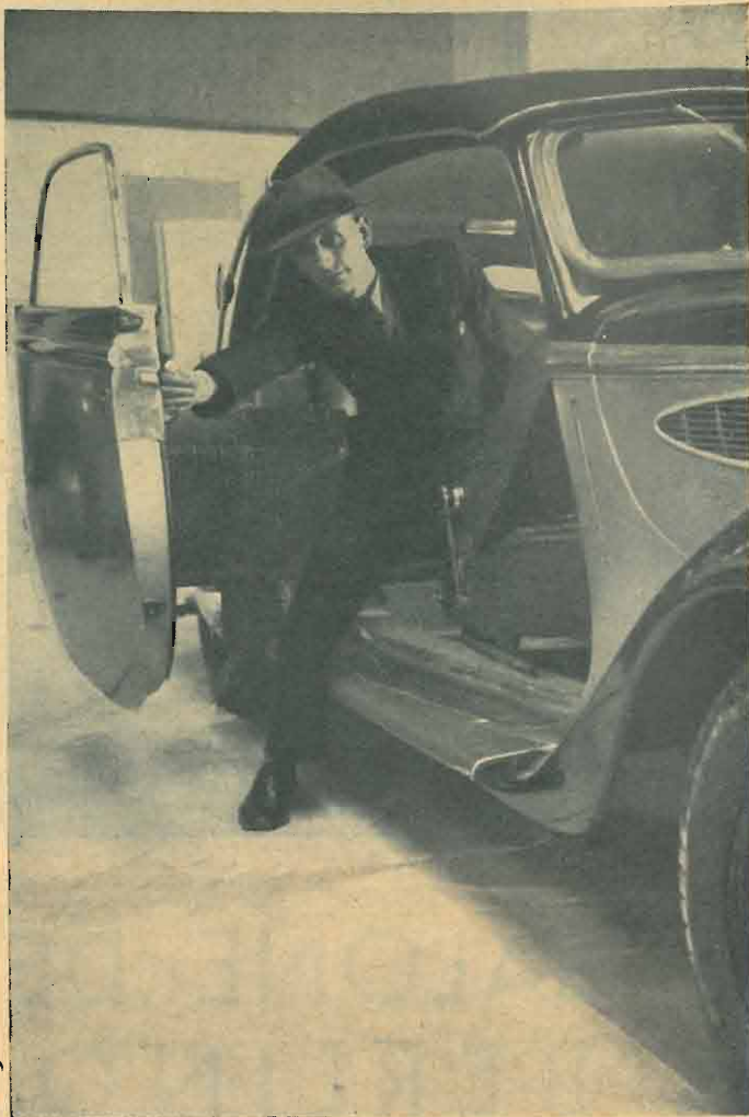
Una innovazione nella carrozzeria cabriolet BMW. La porta di sicurezza che non disturba il traffico quando è aperta.
